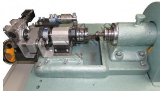
Машина И-47 состоит из следующих основных частей: испытательной установки, силового блока; пульта оператора. Машина предназначена для работы в помещениях лабораторного типа.
