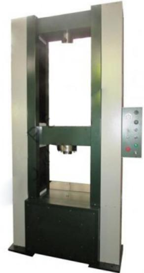
Принцип работы машины заключается в деформации образцов с помощью нагружающего устройства и одновременного синхронного измерения величины силы, приложенной к испытываемому образцу, и соответствующего значения величины перемещения подвижной траверсы (активного захвата).
