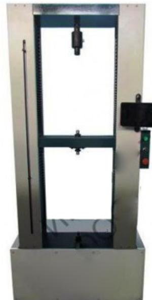
Измерение силы производится путем преобразования нагрузки датчиком силоизмерительным в электрический сигнал, изменяющийся пропорционально прикладываемой нагрузке. Внесена в Госреестр под номером 67314-17.
