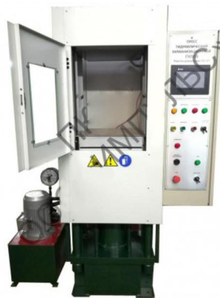
Вулканизационный пресс исполнения ПКМВ-40 оснащен микропроцессорной системой управления и регистрации силовых и температурных показателей испытания.
